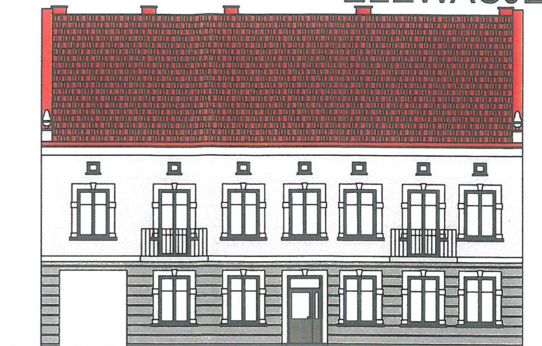
ELEWACJA FRONTOWA - MALOWANIE FARBĄ NA SPOIWIE SILIKONOWYM
